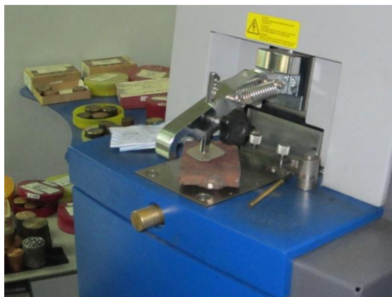
Рис. 1. Установка для определения химического состава наплавки спектральным способом
